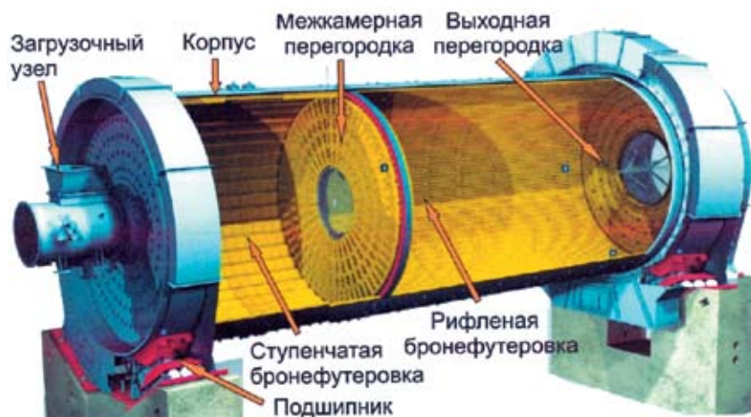
Рис. 1. Основной агрегат цементной промышленности для измельчения цемента – двухкамерная шаровая мельница
