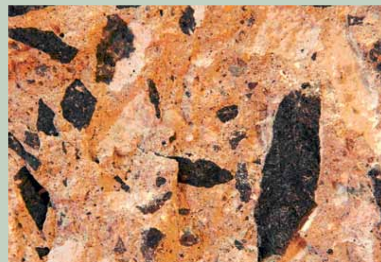
Рис 2. Фотография скола образца бетона состава №2, табл. 2 после механических испытаний. Наблюдается разрушение материала непосредственно по зернам щебня . 7 сут нормального твердения
