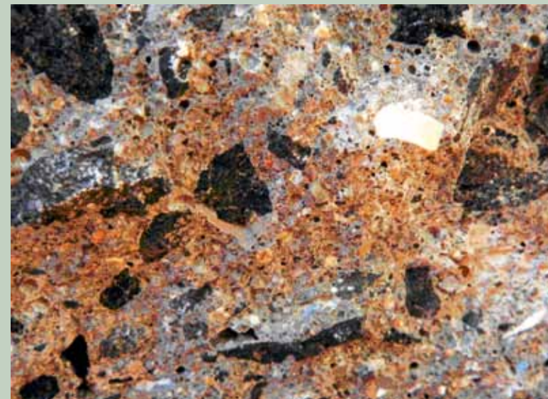
Рис 1. Фотография скола образца бетона состава №1, табл. 2 после механических испытаний. Наблюдается разрушение материала непосредственно по зернам щебня после 28 суток нормального твердения
