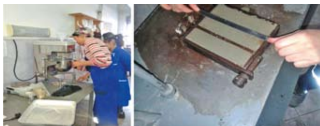
а) Лаборатория б) Формование балочек Рис. 3. Фотографии испытаний произведенного наноцемента 55
