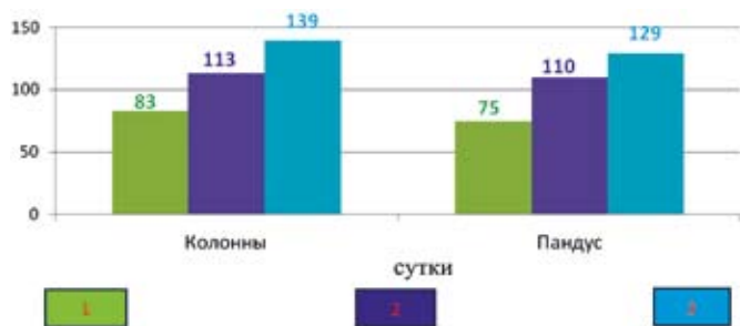
Рис. 6. Динамика набора прочности бетона на конструкциях объекта, %
