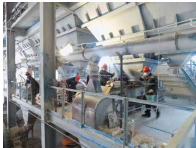
Фото 1. Пост загрузки компонентов на ленту транспортера перед шаровой мельницей во время испытаний
