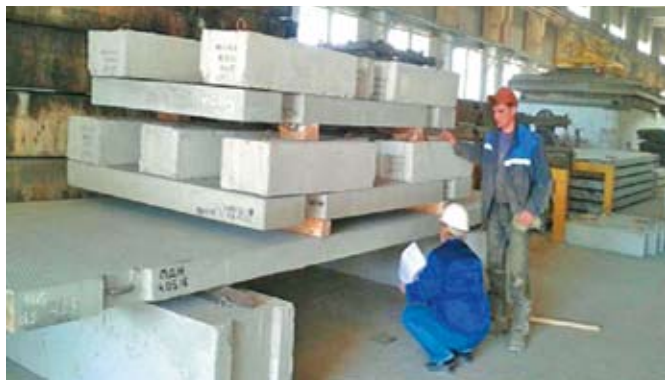
Фото 5. Проверка изделия ПДН 60.20-30 АтV на прочность. Снятие напряжения. Нагрузка — 7720 кг, прогиб составил 6 мм, при норме 30 мм. См: Отчет ИЛ ТОО «Стройдеталь» Исх: 112/11 11
