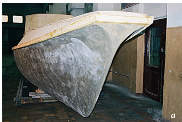
Рис. 1. Яхта с корпусом из наноцемента: а — корпус яхты в экспериментальном цехе (толщина абсолютно водонепроницаемой стенки бортов 12 мм); б — на Клязьминском водохранилище (Московская область, 2009 год)
