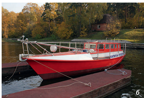
Рис. 1. Яхта с корпусом из наноцемента: а — корпус яхты в экспериментальном цехе (толщина абсолютно водонепроницаемой стенки бортов 12 мм); б — на Клязьминском водохранилище (Московская область, 2009 год)
