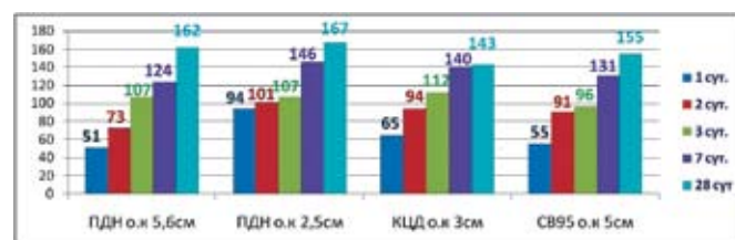
Рис. 3. Динамика набора прочности промышленных изделий из бетона на основе наноцемента 75 по отчету ТОО «Стройдеталь»
